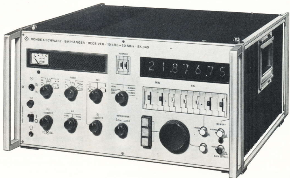
BILD 1 VLF-HF-Empfänger EK 049 als orts- und fern- bedienbares Gerät. Foto 23 301
